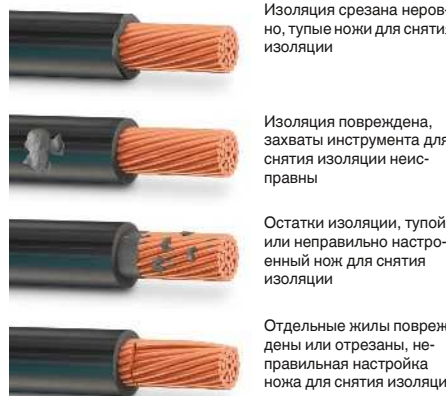
Ошибки снятия изоляции согласно DIN МЭК 60352-2
