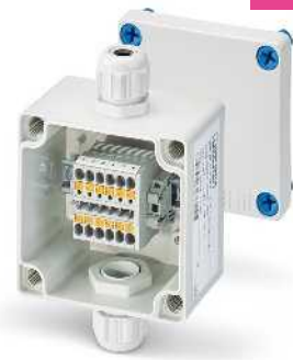
Клеммная коробка с 6 клеммами сечением 2,5 мм 2 с технологией соединения push-in
